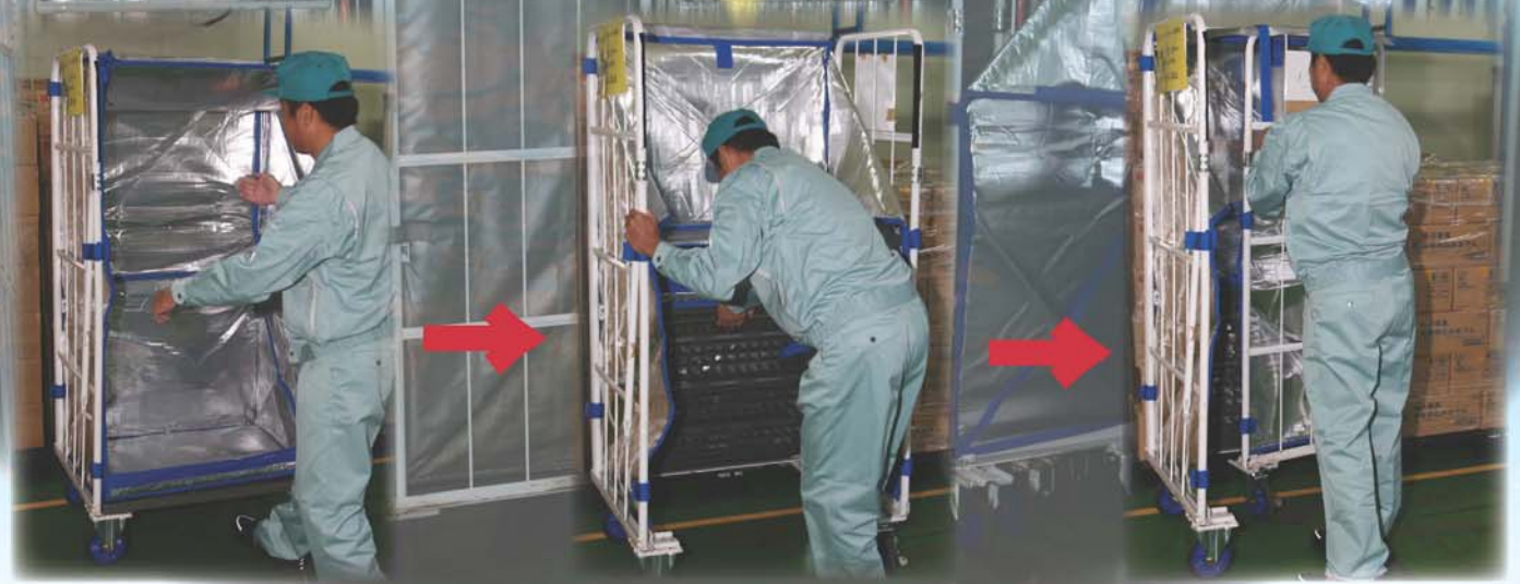
3.台車右側を折りたたみ マジックテープで固定
